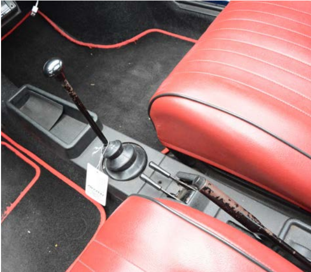
Technische Besonderheit: die kleinen Hebel in der Mitte sind der Choke für den Kaltstart (links) und der Anlasser (rechts).
