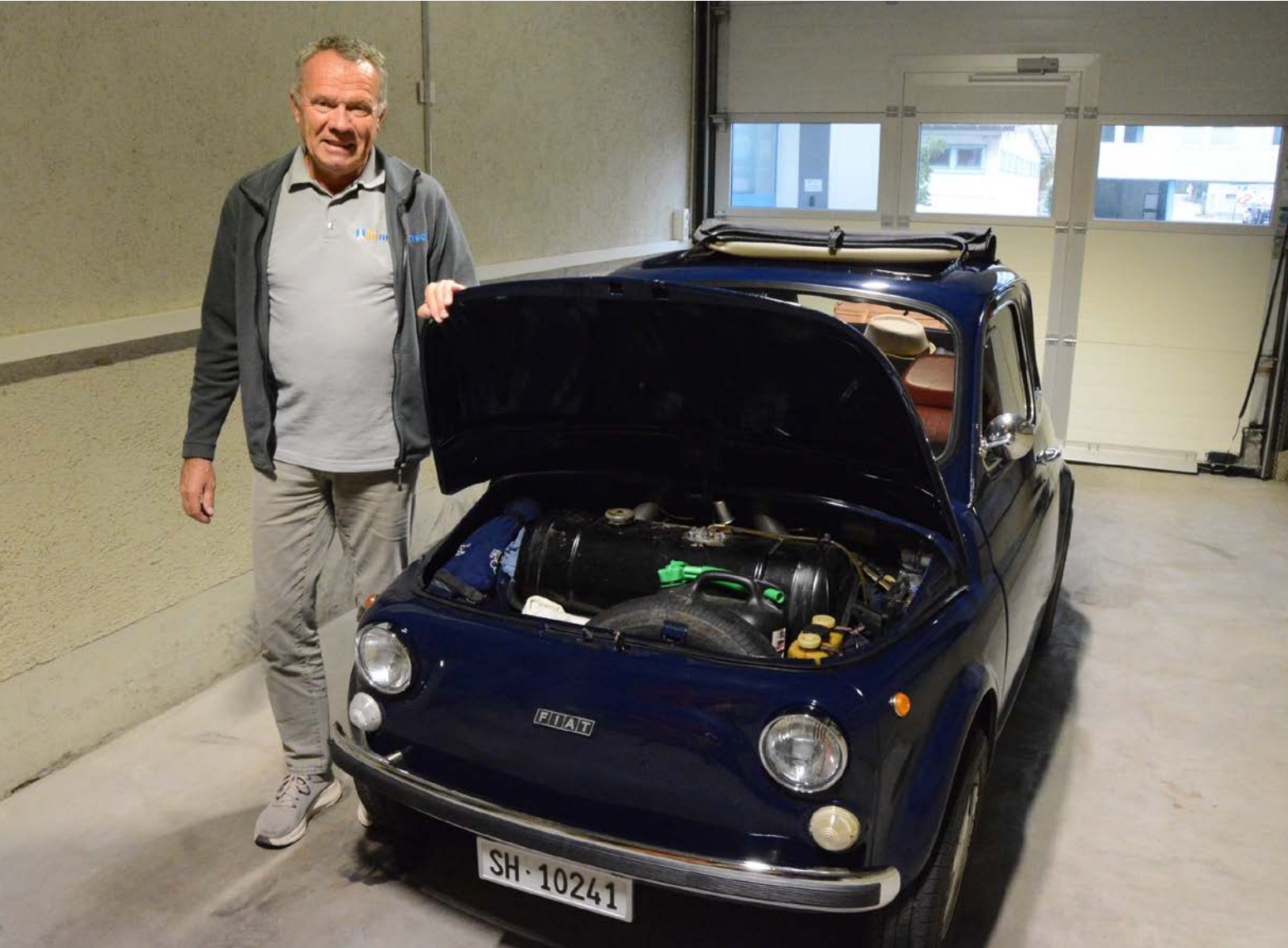
Stefan Hitz ist stolzer Besitzer eines Fiat 500 F. Vorne sind Bezintank, Reservekanister und Ersatzrad untergebracht. Der Motor ist hinten. Auf dem Bild wird ersichtlich, wie klein das italienische Auto ist im Vergleich zum Fahrer.
