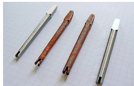
Über 400 Jahre alte Stimmstifte einer Harfe mussten ersetzt werden. Die Teile wurden neu konstruiert und automatisch produziert.
